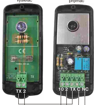
fotobunky DIR Tx vysielateľ Rx prijímač
